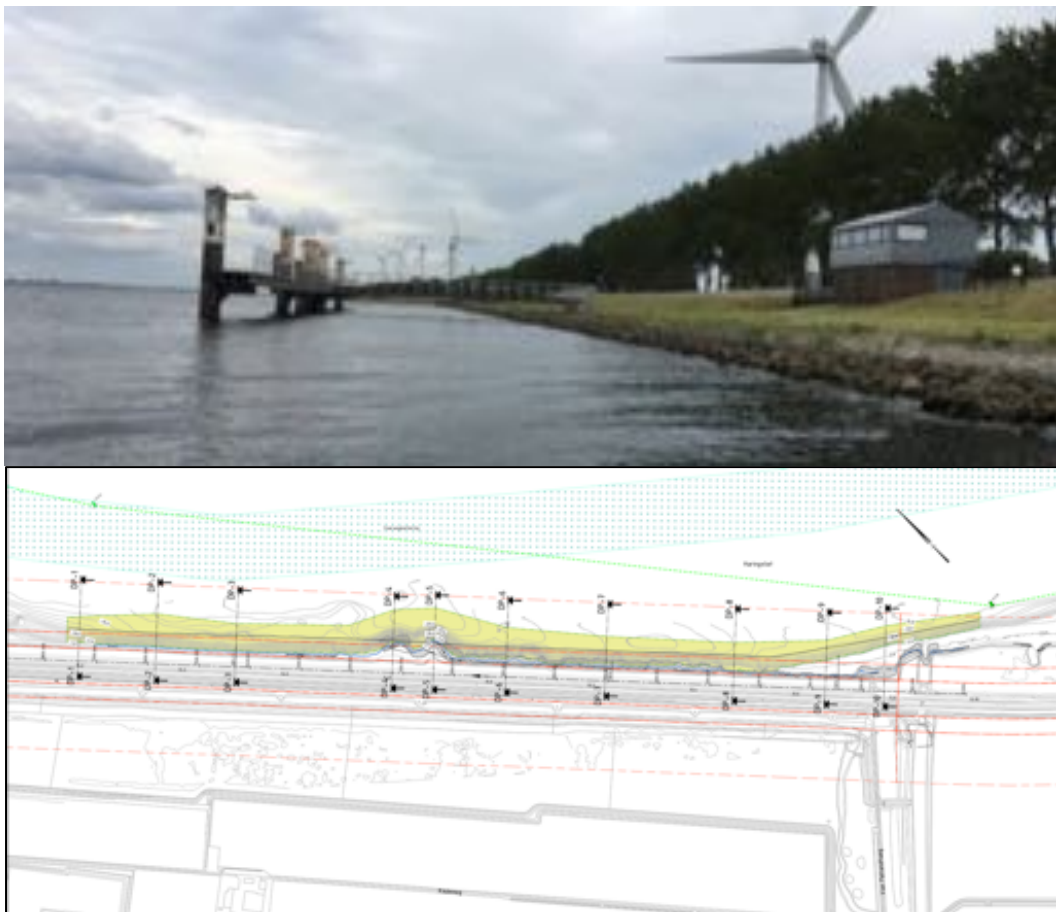
Figuur 2 De huidige situatie (boven) en het vooroeverbrestortingsplan (onder) langs het Haringvliet bij Middelharnis.
