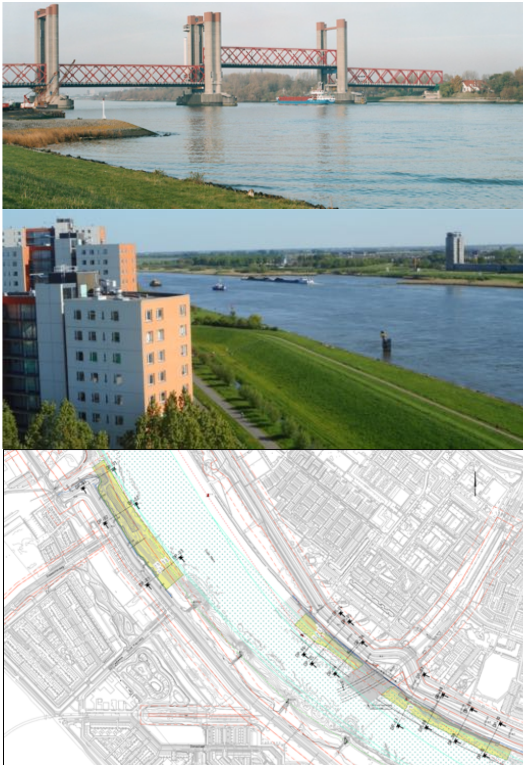
Figuur 4 De huidige situatie langs de zuidoever (boven) en noordoever (midden), en het voorveer bestortingsplan (onder) langs de Oude Maas.
